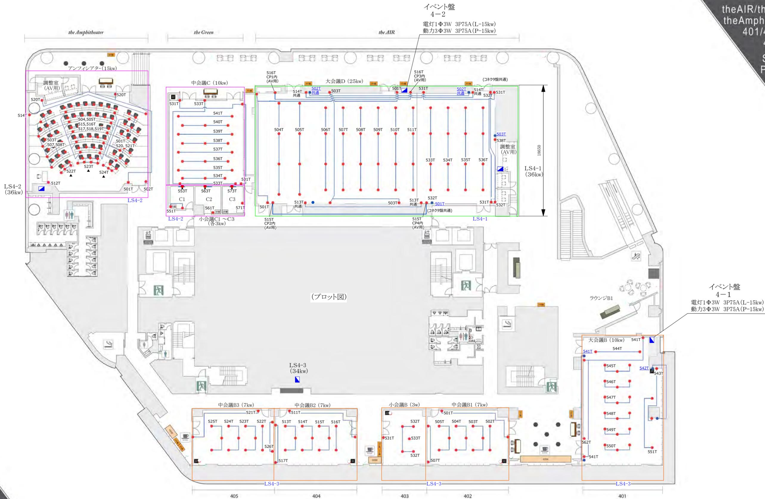
※ 二次側には漏電ブレーカを必ず接続し使用してください。各コンセント回路から電源を使用する場合もブレーカを接続しご利用ください。(警報アラーム値 F30)
