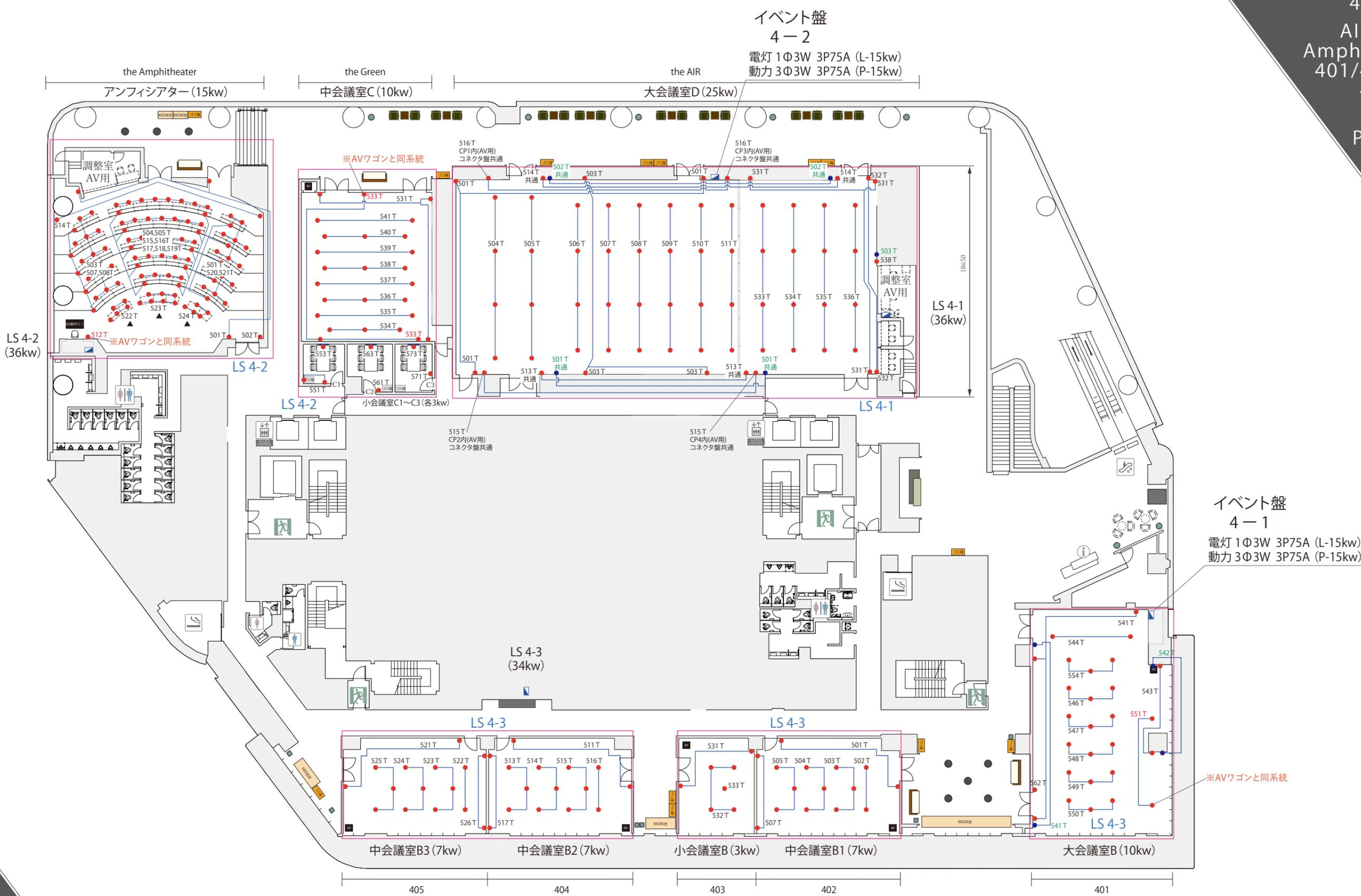
※二次側には漏電ブレーカを必ず接続し使用してください。
